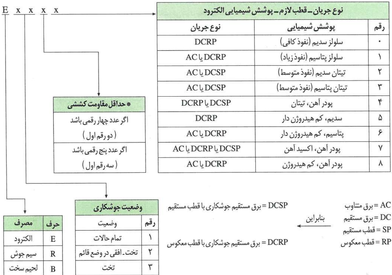
جدول شماره ۳ - طبقه بندی الکترودها توسط انجمن جوش آمریکا (A W S) American Welding Society
